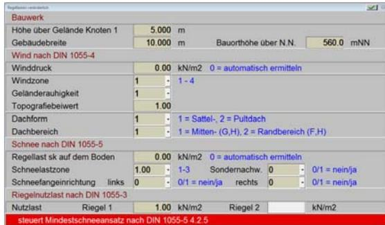
Die automatische Ermittlung der Schnee- und Windlasten kann wahlweise durch eine direkte Lasteingabe ausgeschaltet werden. Über die Dachform und den Bereich (Mitte oder Rand) werden die Windeinwirkungen festgelegt.
