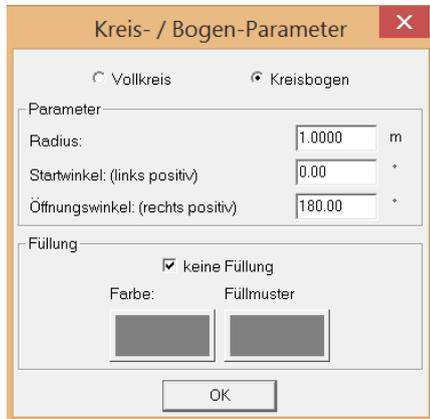
Hier wird die Form des Kreises bestimmt. Über den Radius, den Startwinkel und den Öffnungswinkel können beliebige Kreisbögen oder Vollkreise bestimmt werden.
